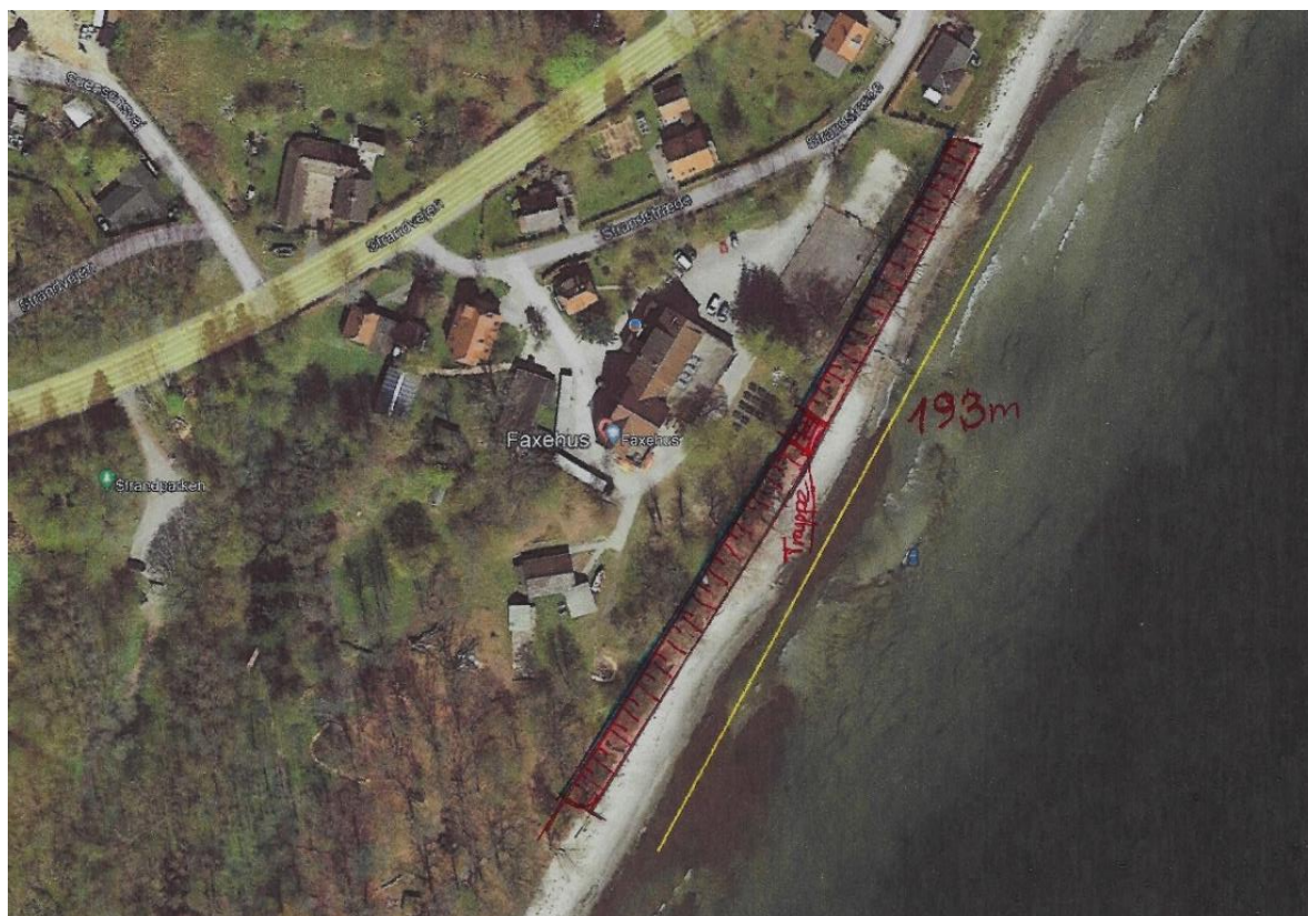
Figur 4-6 Planløsning for Skræntfodsbeskyttelse på 193 m ved Efterskolen
