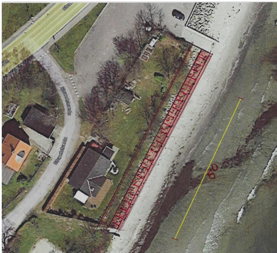
Figur 4-4 Planløsning for skræntfodsbeskyttelse på Strandstræde 1. Længde 63 m.
