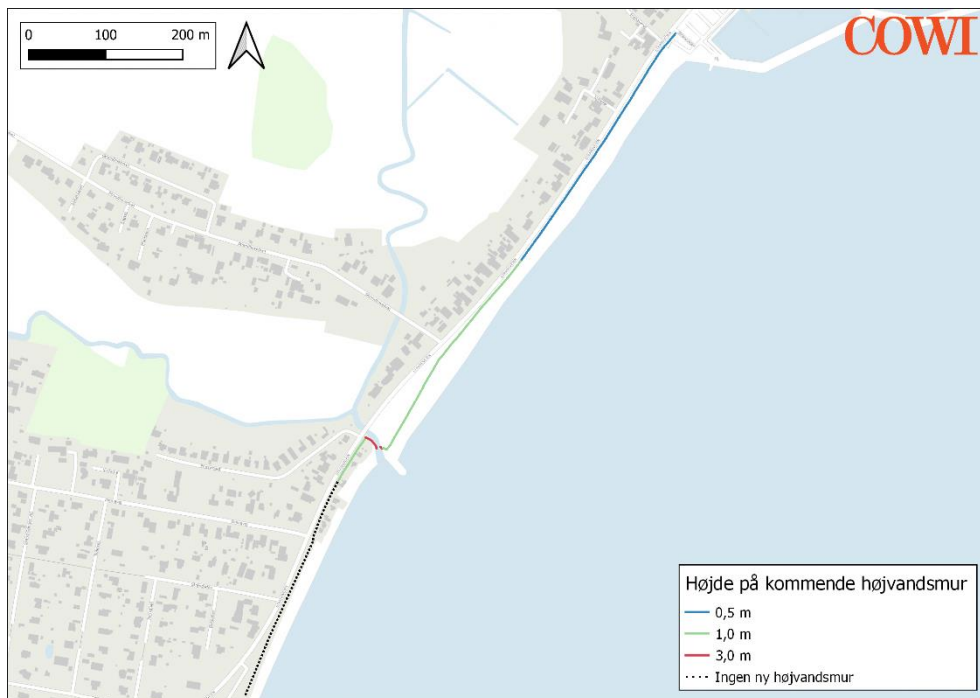
Figur 5-1 Gennemsnitshøjde på kommende højvandsmur
