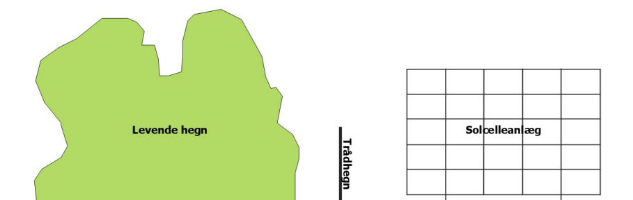
Figur 1: Skitse der viser placeringen af det levende hegn i forhold til trådhegn og paneler. Trådhegnet skal være 2 meter højt, så det store hjortevildt i mindre grad vil forsøge af forcere det, hvorved risikoen for skader på det store hjortevildt mindskes.
