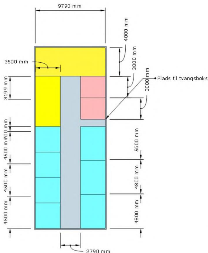
Figur 5: Viser indretningen af staldbygningen.
