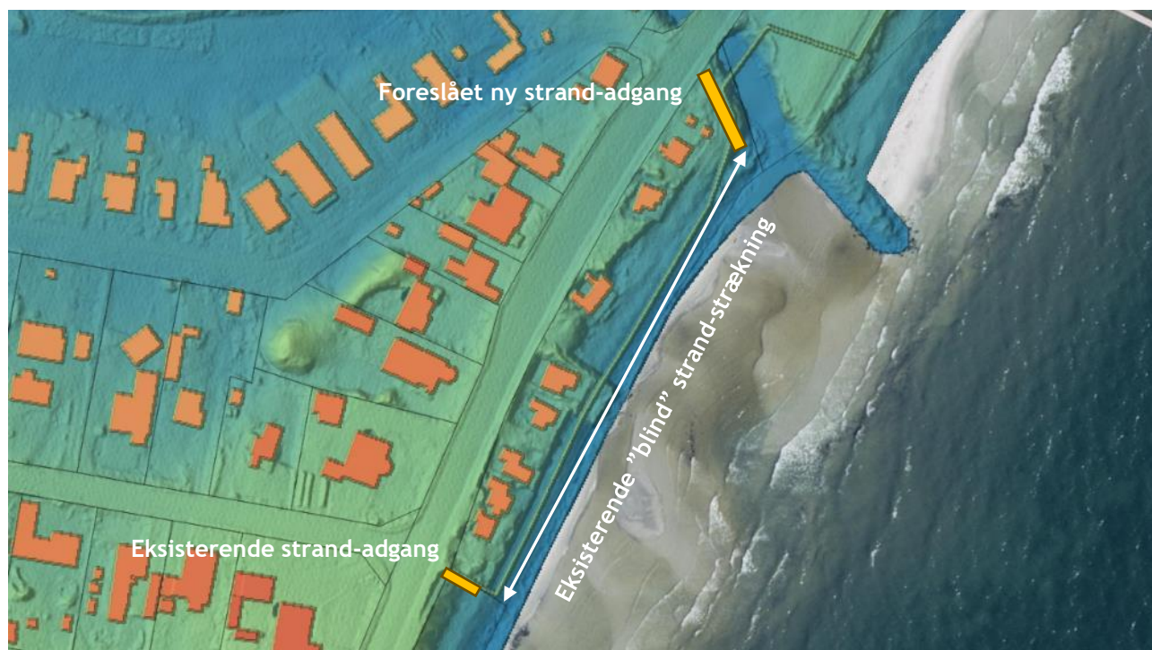
Figur 2-11 Spuns mellem ny sluse og Strandvejen ved Elmuevej. Det foreslås at etablere en ny stiadgang fra Strandvejen ved slusens sydlige landfæste (gult rektangel), for at sikre adgang for drift/vedligehold til sluse og bagvandspumper, samt for at øge offentlighedens muligheder for at færdes langs stranden. Forløb af ny spuns/højvandsmur er vist med grøn linje. Modellering fra Scalgo Live.
