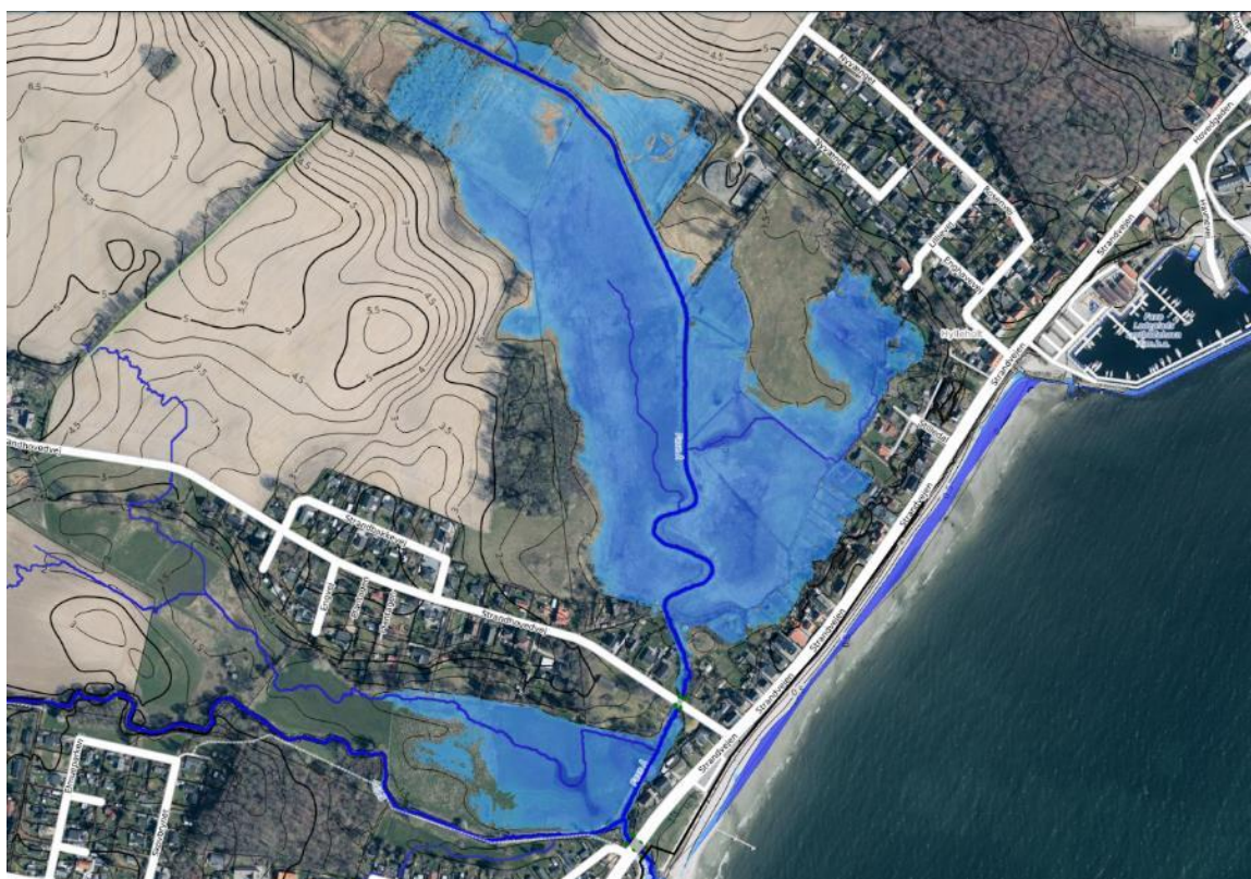
Figur 4-22 Opstuvning langs Faxe Å og Lilleå ved en havvandstand i kote 0,9. Højere vandstand vil medføre bygningsoversvømmelse startende på strækningen mellem Strandvejen 28 og 42. Engarealet, hvorpå der vil kunne opstaves vand ses tydeligt langs Faxe Å.
