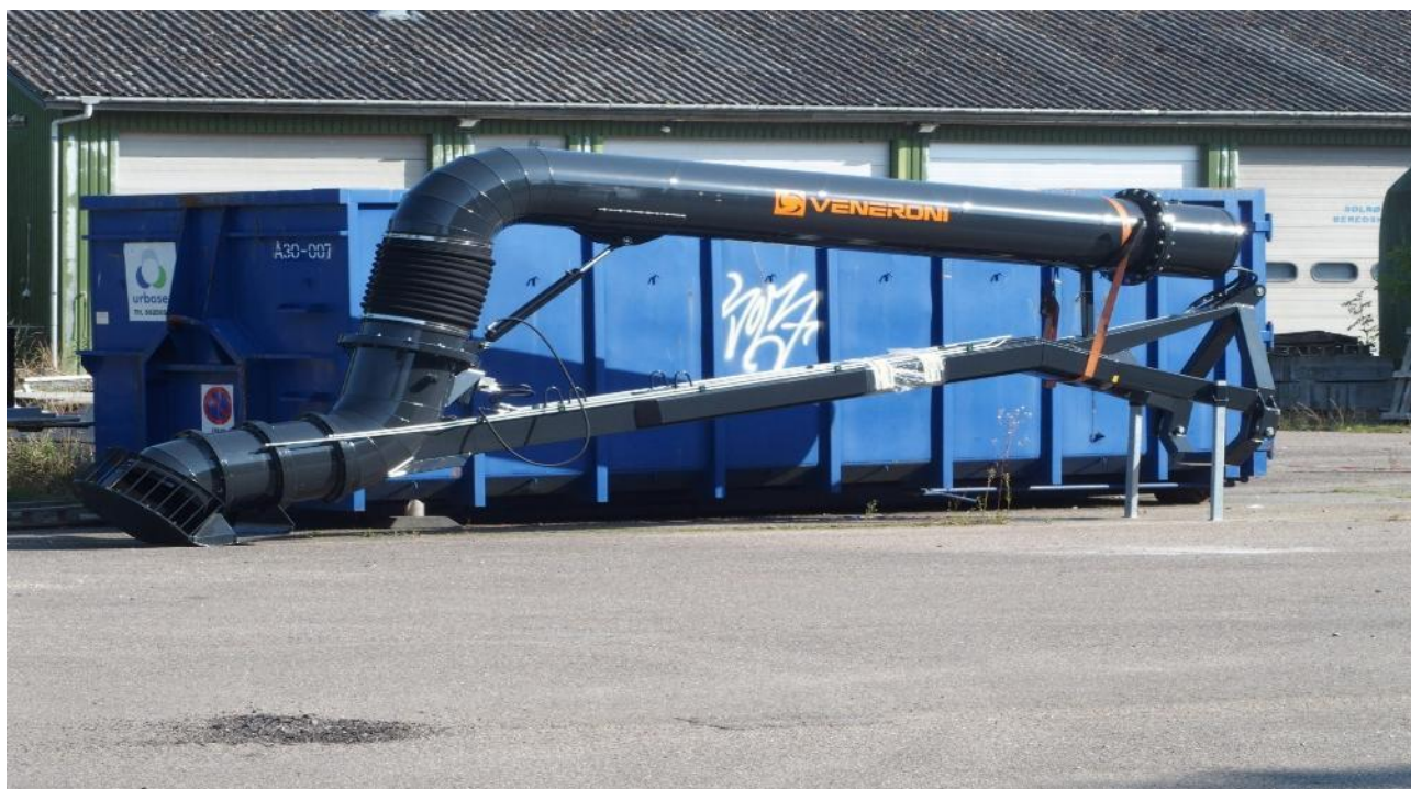
Figur 4-4 Traktorpumpe med en ydelse på 1000 l/s. Indkøbt af Solrød Kommune.
