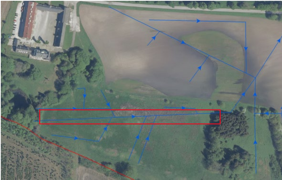
Kortudsnit 1b: Hovedledningen med dimensionen ØXX er faldet sammen, og som lodsejer ønsker at grave op som en åben grøft med slyngninger i stedet for at erstatte med en ny hovedledning.
