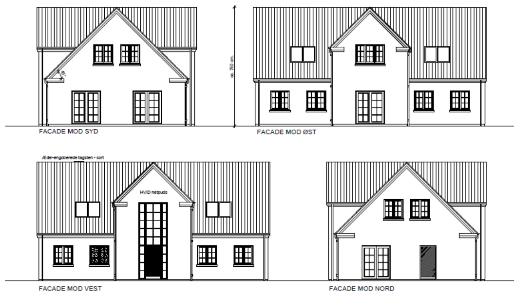
Figur 2. Figuren viser facaderne på den nye bolig fra alle sider.
