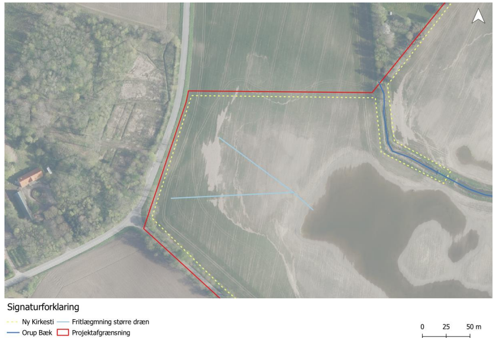
Figur 3-12 Frilægning af de to større dræn fra Skovridderskoven.
