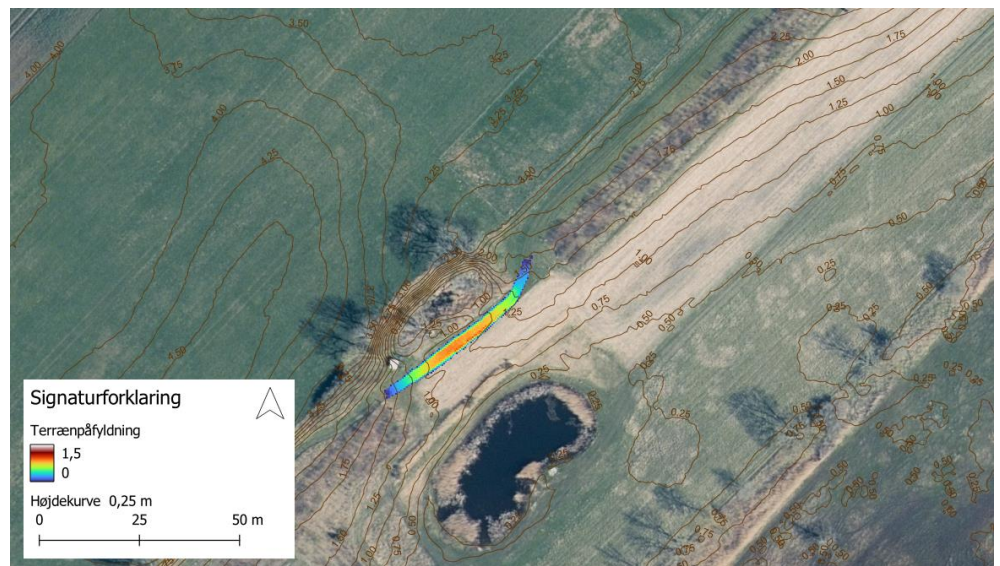
Figur 3-11 Difference mellem eksisterende terræn og hævnningen af vejen til kote 1,75 m DVR90.
