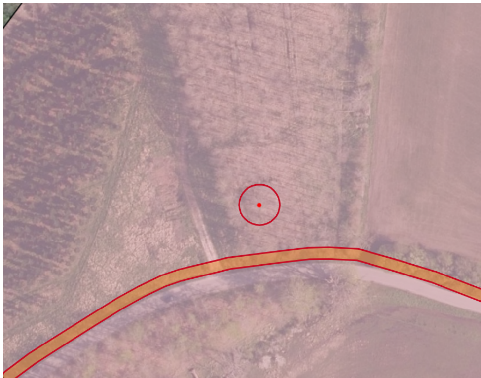
Figur 1. Arbejdsareal på 4 meters bredde omkring drikkevandsledning sammenholdt med udstrækning af rundhøjen (rød cirkel).
