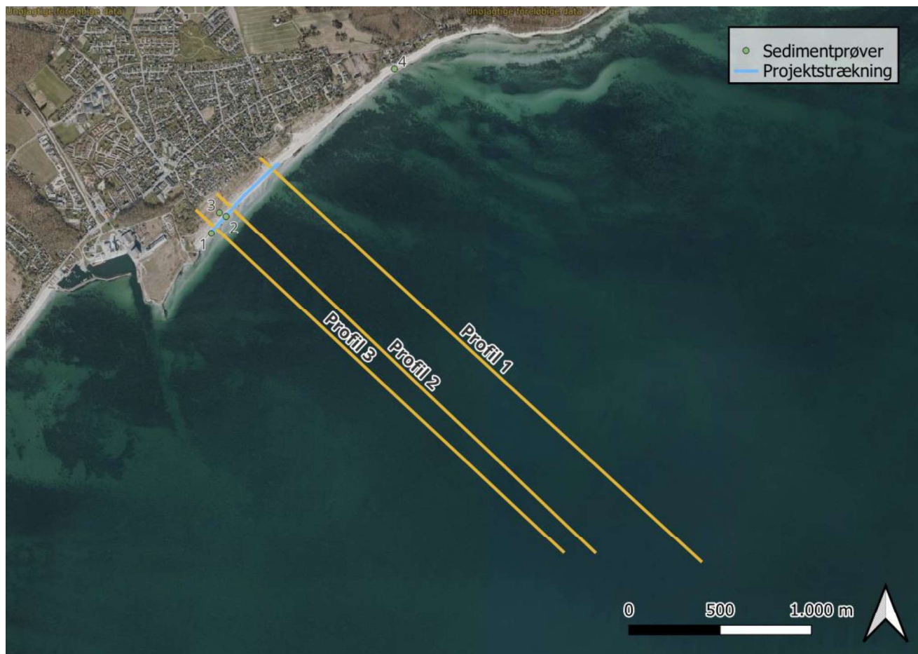
Figur 4.1: Kystprofiler i projektområdet (orange linjer) og sedimentprøvetagning (grønne punkter).
