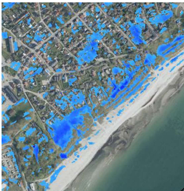
Figur 2.8: Vand på terræn ved en 10 års regnhændelse. Nedsivning indgår ikke i vurderingen, og visualiseringen repræsenterer derfor en konservativ vurdering af vandstanden. Baggrundskort: (Klimadatastyrelsen, Ortofoto Forår 2024).
