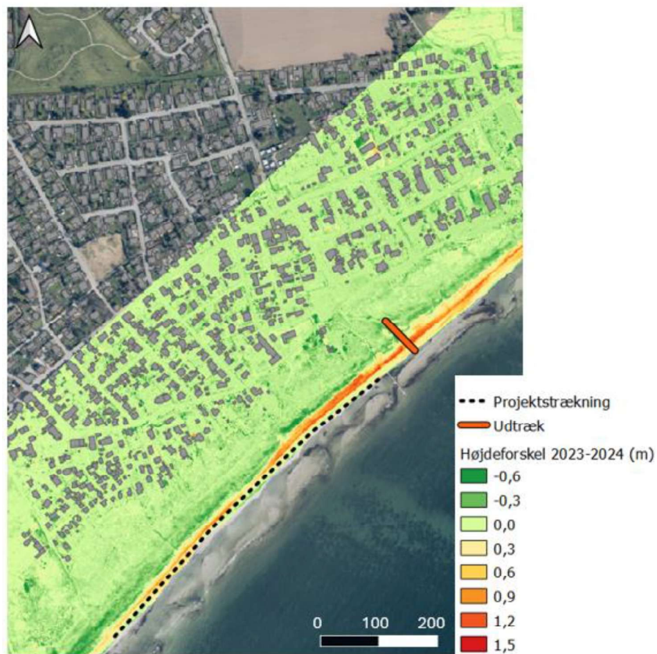
Figur 2.3: Højdeforskel mellem terræn fra 2023 og 2024. Positive værdier (rød/orange) viser, hvor terrænet er sænket fra 2023 til 2024. Negative værdier (mørkegrøn) viser, hvor terrænet er hævet fra 2023 til 2024. Et udtræk af terrænet på tværs af kysten (rød linje) er markeret og resultatet vist på Figur 2.4
