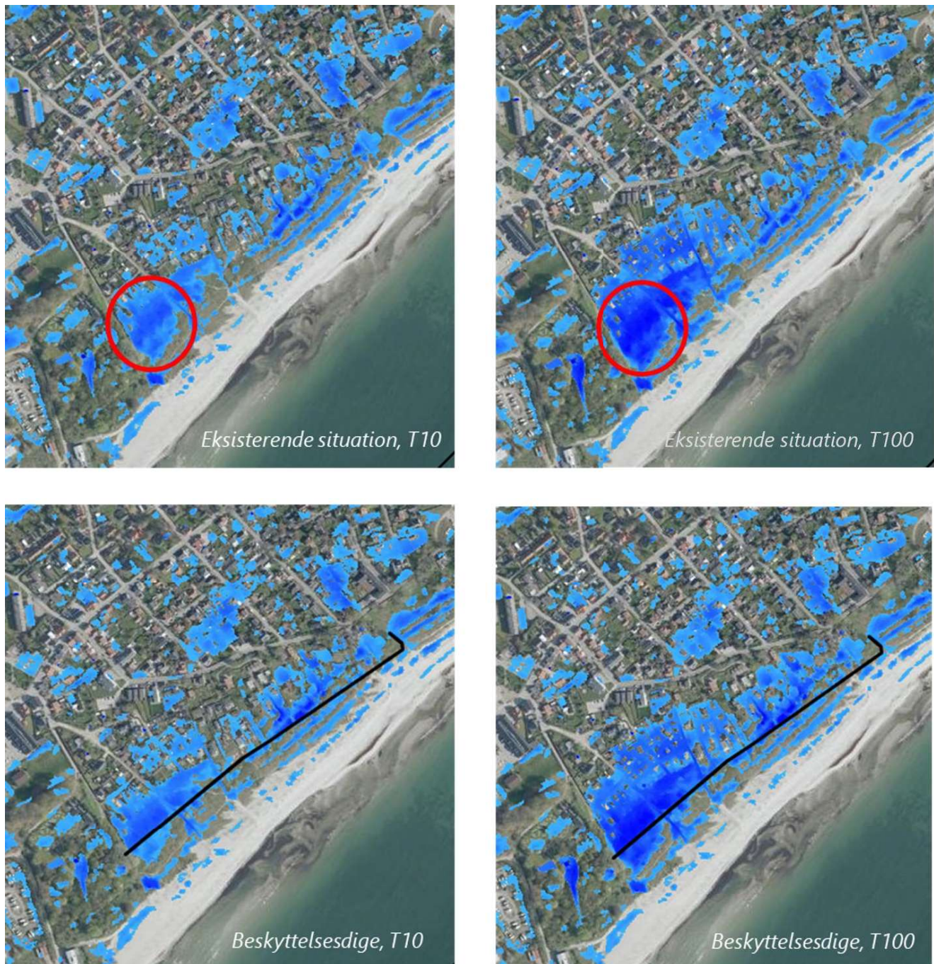
Figur 4.2: Oversvømmelseskort ved den eksisterende og fremtidige situation for en 10 (T10) og 100-års hændelse (T100). Den sorte streg viser placeringen af diget. Baggrundskort: (Klimadatastyrelsen, Ortofoto Forår 2024)
