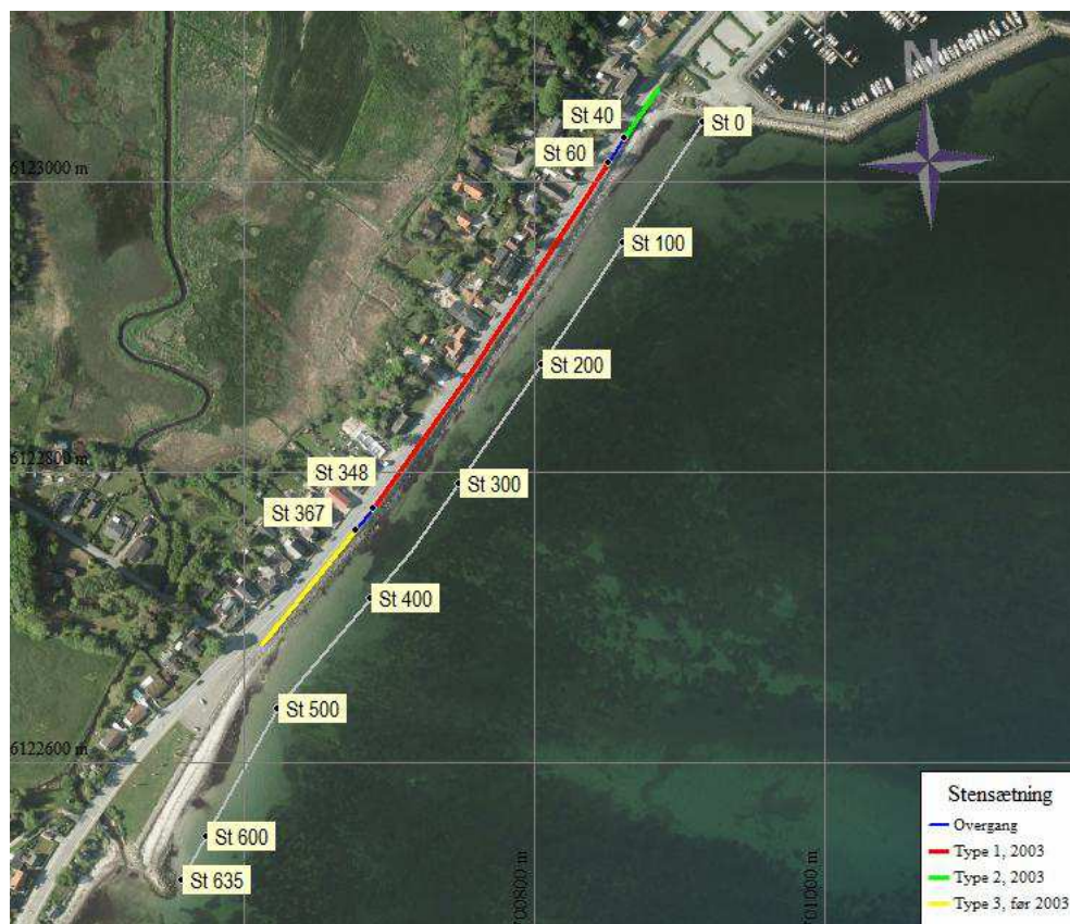
Figur 5.1 Skitse af de forskellige stenkastningstyper.
