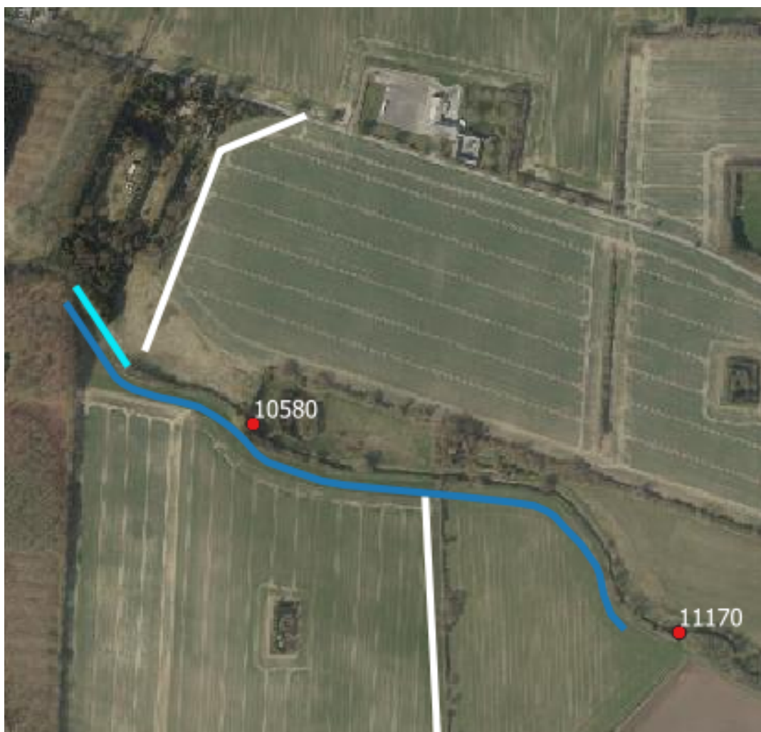
Figur 4 Adgangsveje til delstrækning 5. Udlægning af groft materiale (blå markering). Ved den turkise markering bør mudder fjernes inden udlægning.
