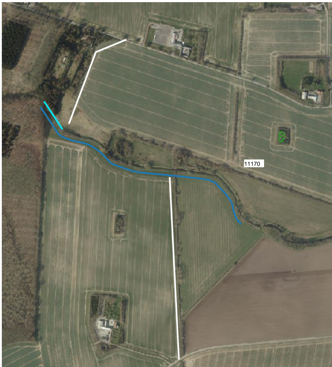
Figur 8 Udlægning af sten (blå markering) og grydegrus efter fjernelse af mudder og vandplanter (turkis markering) på delstrækning 5. Adgangsvej markeret med hvid.
