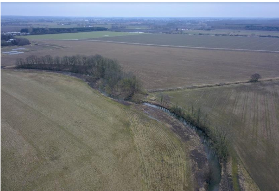
Figur 33 Strækning omkring st. 11170 i de to sving foreslås at der udgraves dobbeltprofil på venstre brink
