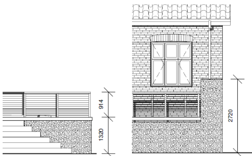
Figur 1: Udklip af facadetegning mod vest, der viser gulvplanets og wire-værnets højde over terræn på 1,32 meter pålagt 0,91 meter (t.v.) og udklip af facadetegning mod øst, der viser nordvendte vægs højde over terræn på 2,72 meter.
