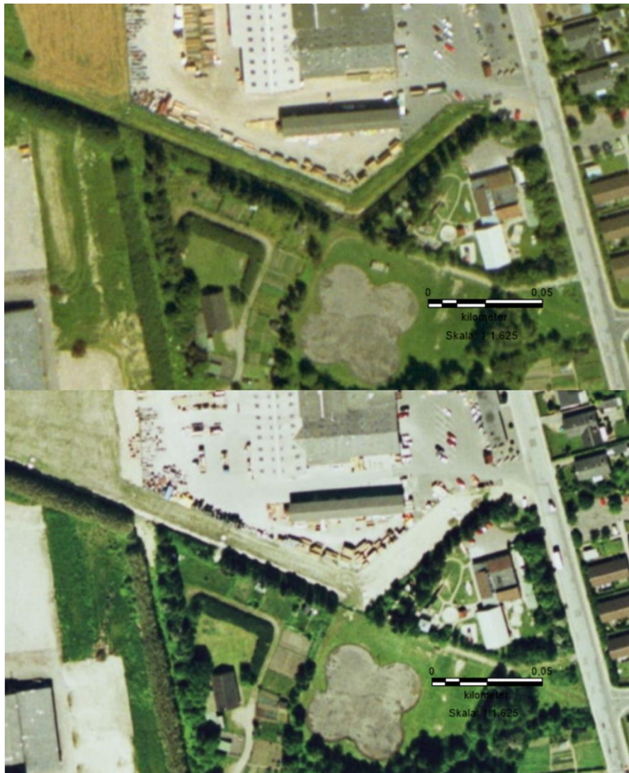
Figur 4. Øverst: luftfoto fra 1999, med tydelig åben grøft med start vest for Maglemosevej. Nederst: luftfoto fra 2002, efter rørlægning af grøft.
