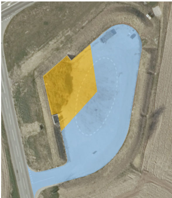
Figur 1. Pladsen indrettes, så det gule område er tæt belægning med tilkobling til den offentlige spildevandsledning. Det blå område er befæstet med nedsivning til siverender og sivebassin.
