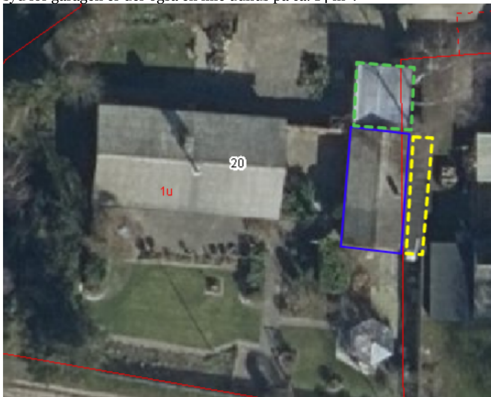
Kort 1 – kort over ejendommen. Garagen (blå) med tilbygget carport (grøn) mod nord, og tilbygget træskur (gul). Den røde linje markerer matrikelskel 1 .
