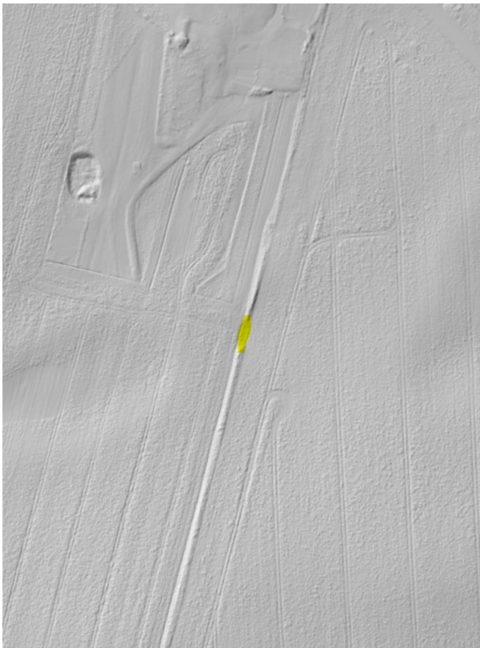
Højdemodellen med den lave strækning ca. 124 meter fra nord enden af diget D00.107.721
