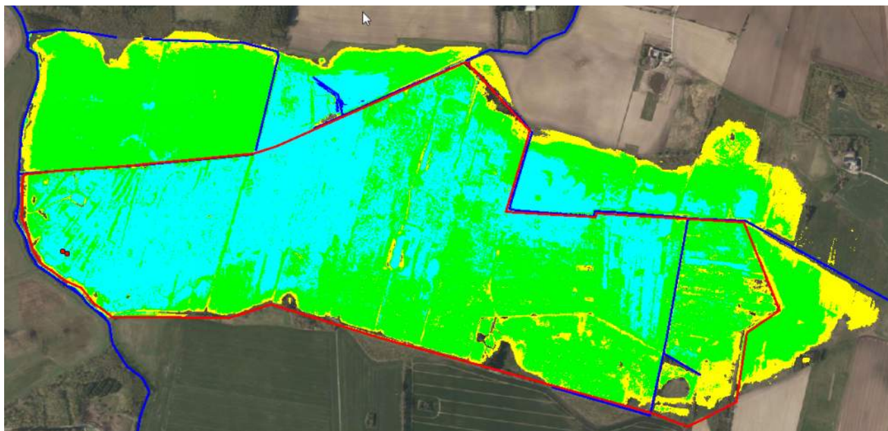
Figur 2-15 Udbredelsen af oversvømmelser baseret på data fra Miljøstyrelsens loggere (2 røde prikker). Lys blå (kote 27,70) oversvømmes normalt jan-mar. Det grønne areal (kote 28,00) oversvømmes i nogle år og det gule (kote 28,22) sjældent. Kortet er baseret på koterne og skal tages med forbehold, fordi vand-spejlet ikke vil være det samme over hele det store område.
