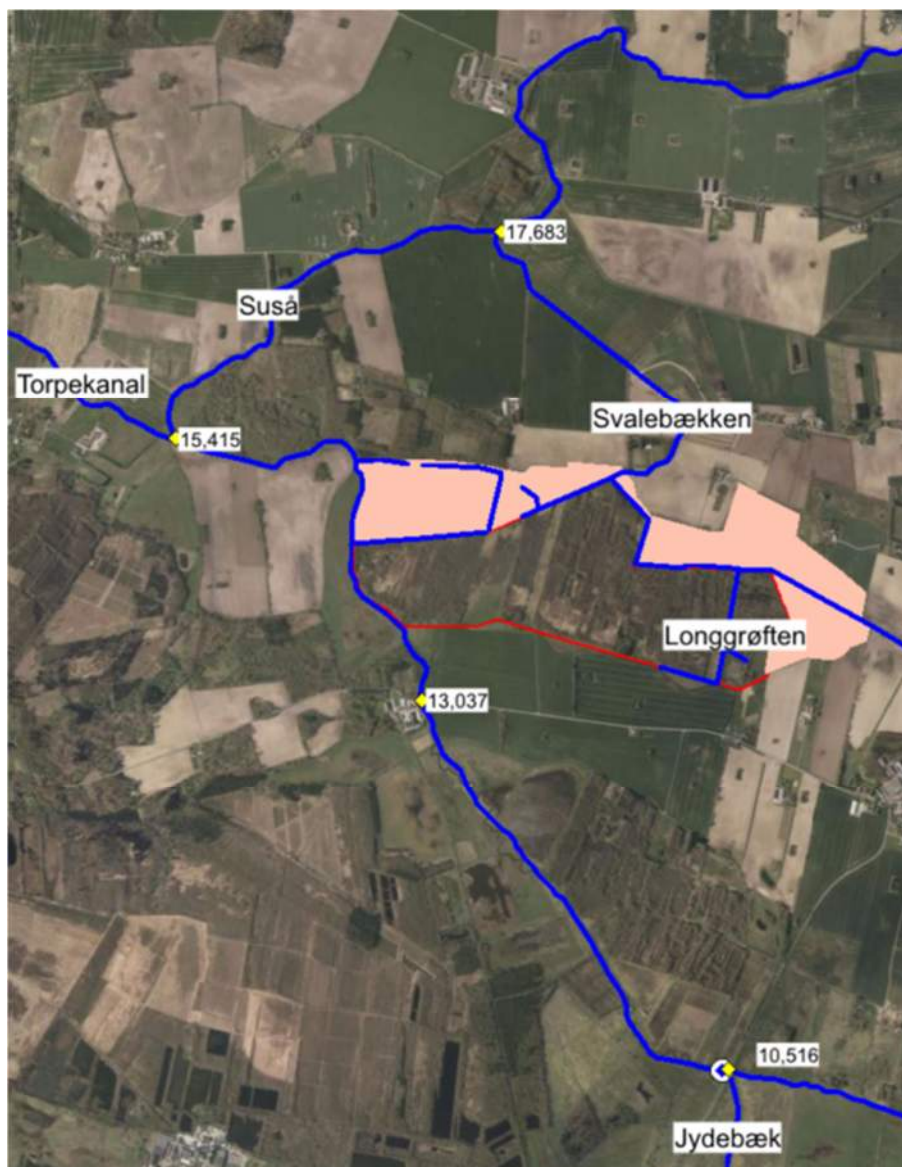
Figur 2-6 Overordnet hydrologi. Faxe Kommune driver en målestation, der måler vandstanden i Suså lige nedstrøms tilløbet af Jydebæk. Suså afgiver vand til Torpekanal ved et fordelerbygværk.
