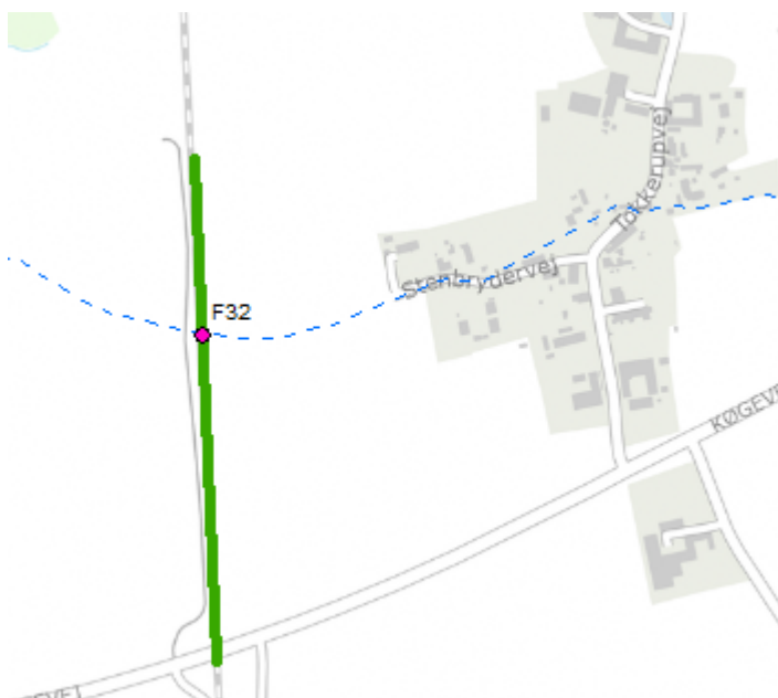
Figur 1 Udledningspunkt ved banelegemet. Grøn viser uændret opland. Stiplet blå er Gyllemosebæk, der er rørlagt.
