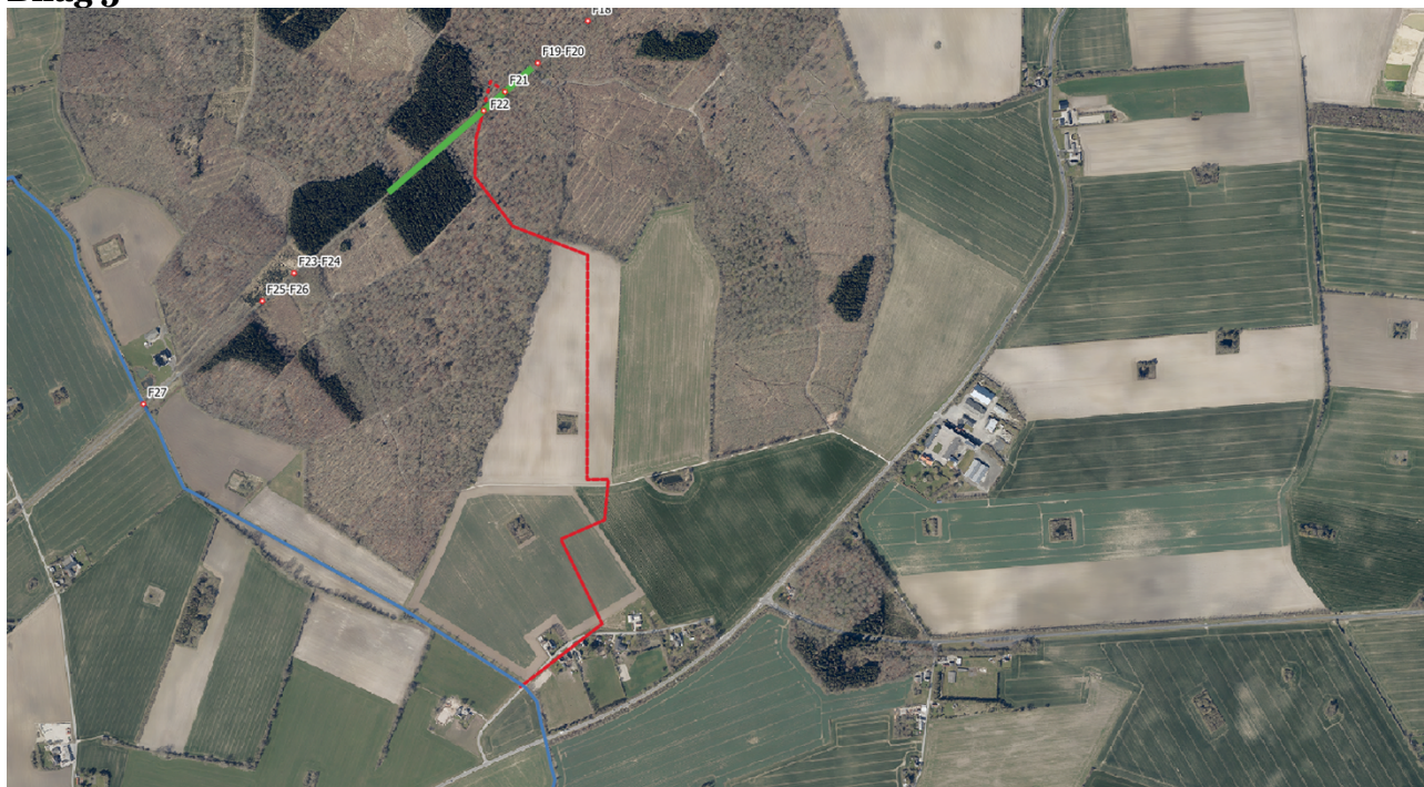
Figur 8 Udledningspunkt F21 og F22. Grøn linje er baneoplandet, rød linje er vandets vej til recipient og blå linje er Vivede Mølleå
