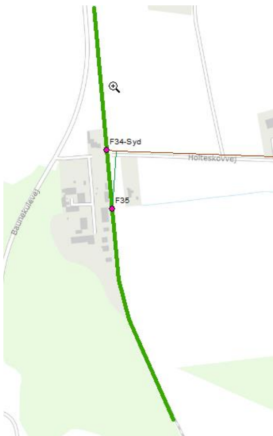
Figur 1 Udledningspunkter ved banelegemet. Grøn viser, at opland er uforandret.
