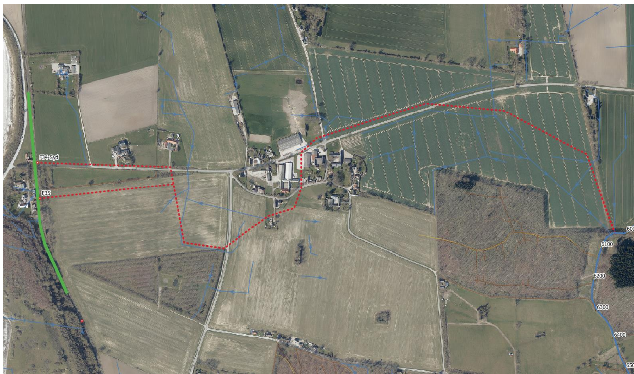
Figur 8 Udledningspunkt F34s og F35. Rød linje er vandets vej til recipient, blå linje er Vivede Mølleå
